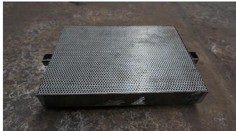
**Gambar 4.12** Hasil pembuatan *Vacuum Chamber*
