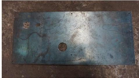
**Gambar 4.30** Hasil pembuatan *cover* kanan
