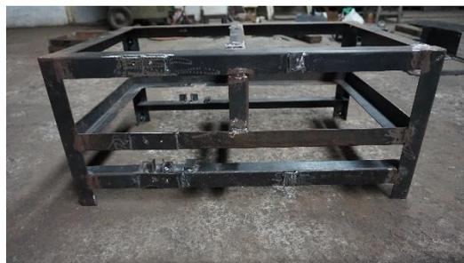
**Gamabar 4.6** Hasil pembuatan rangka mesin
