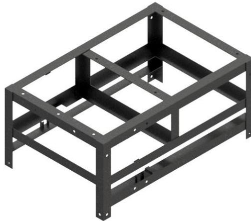
**Gamabar 4.1** Desain 3D rangka mesin *vacuum forming*
