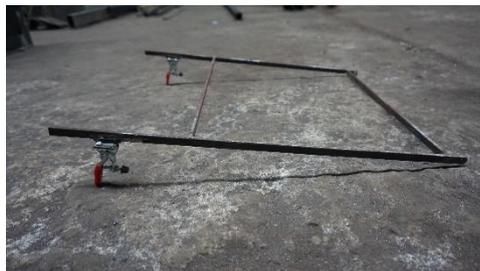
**Gambar 4.15** Hasil pembuatan *Clamp*
