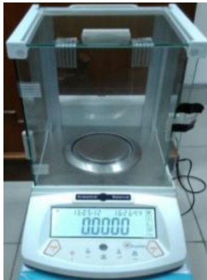
Gambar 3.21 Pengukuran massa benda kerja menggunakan timbangan digital
