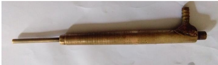
Gambar 3.3 Tool elektroda kuningan berlubang
