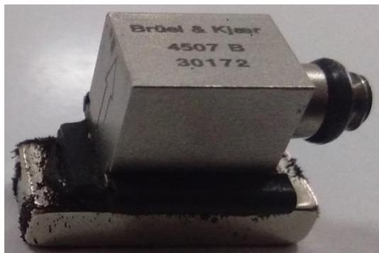
Gambar 3.6 Accelerometer
