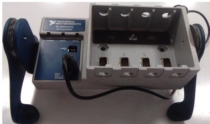
Gambar 3.8 Chassis Modul Data Akuisisi
