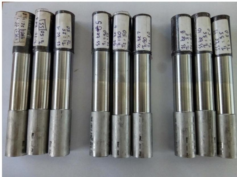
Gambar 4. 8 Spesimen Pengujian Tarik Pipa JIS Z 2201 No. 14C
