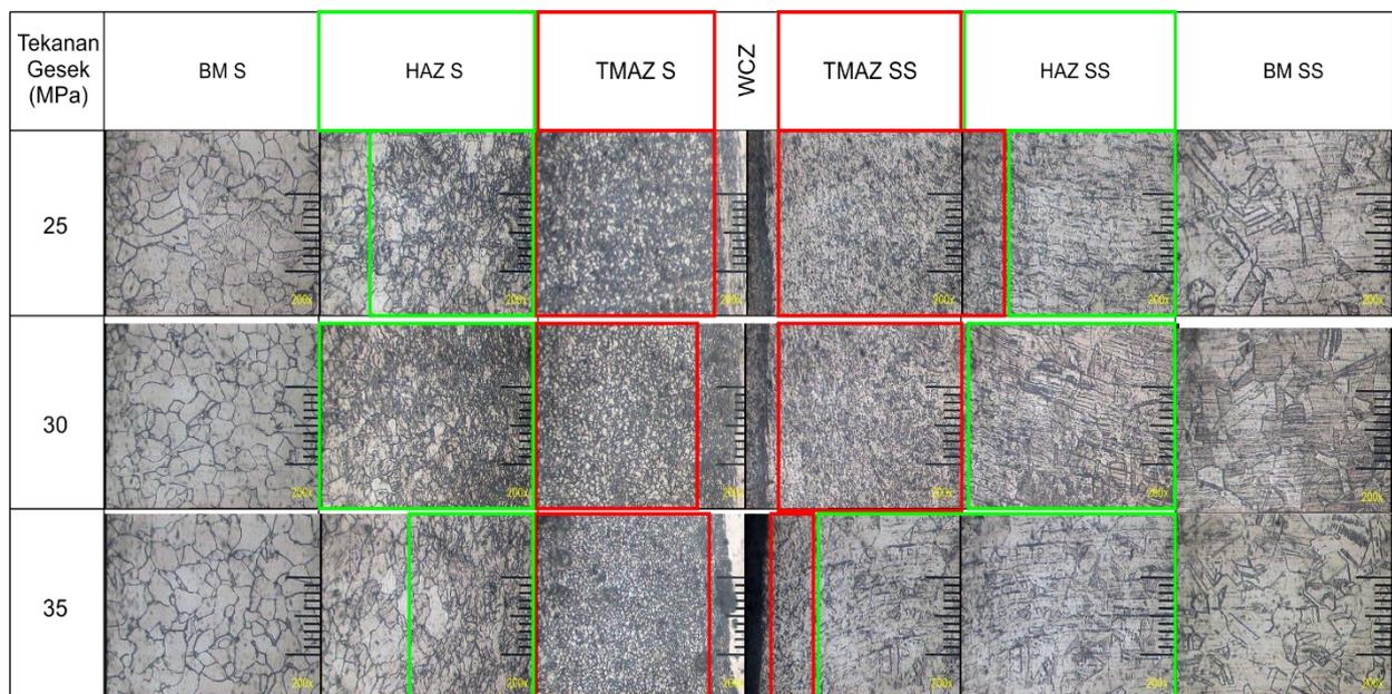
Gambar 4. 4 Hasil Pengujian Struktur Mikro dengan Variasi Tekanan Gesek 25, 30 dan 35 MPa (perbesaran 200x)
