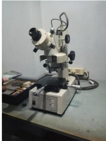
*Gambar 3. 5 Mesin Uji Kekerasan Vickers (Laboratorium D3 Teknik Mesin UGM)*
