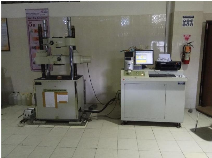
*Gambar 3. 4 Mesin Uji Tarik*
