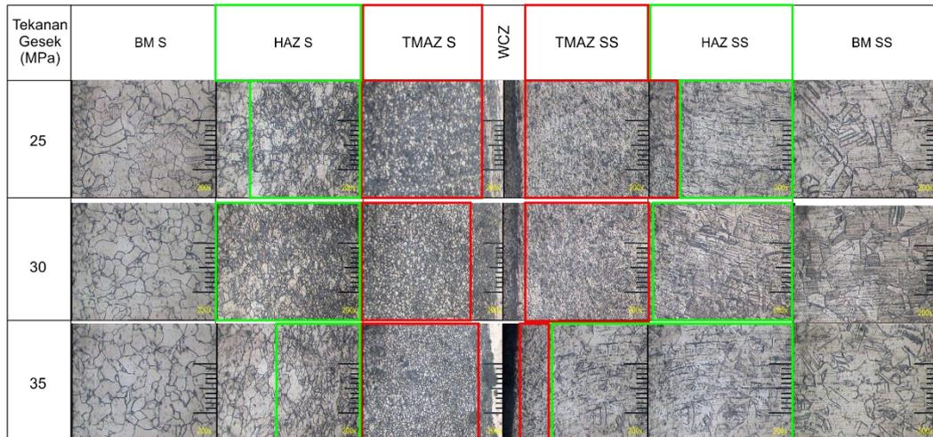
Gambar 5. Hasil Pengujian Struktur Mikro
