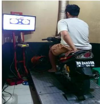
Gambar 3.4 *Dynamometer*
