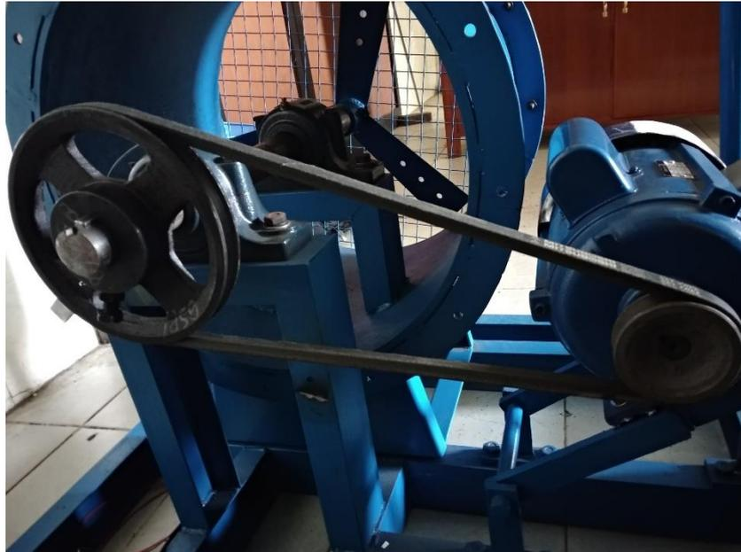
**Gambar 3.18** Belt-Pulley antara Motor Listrik dan Fan Aksial
