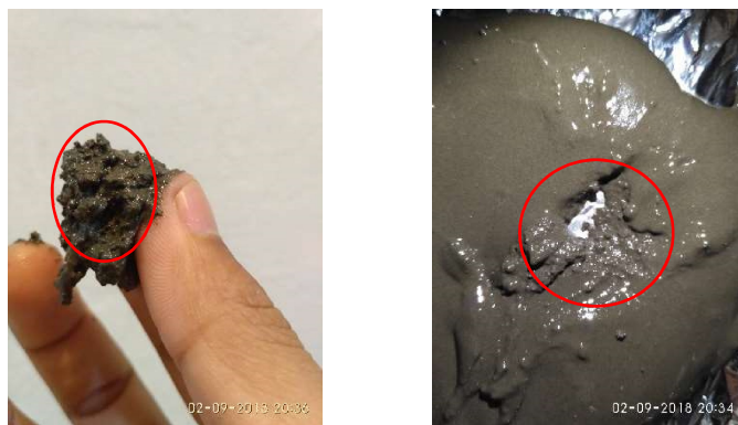
Gambar 4.7 Terjadi penggumpalan setelah pencampuran
