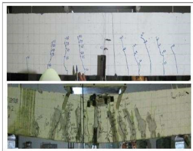
Gambar 2.5 Pola retak pada balok sebelum dan sesudah injeksi epoxy (Puspita dkk., 2018)
