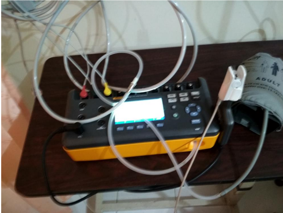
Foto Fluke NIBP Simulator Prosim 8 sedang di operasikan
