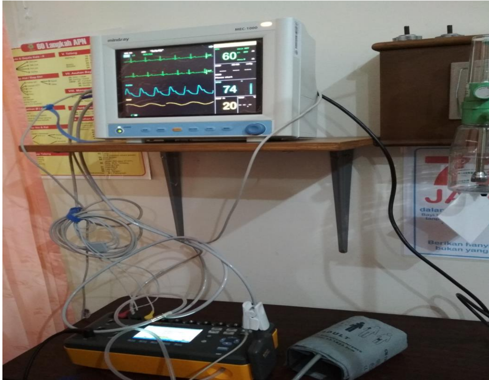
Pada foto ini adalah proses kalibrasi pada pengukuran Systole pada pasien monitor Zondan Zd 120d menggunakan metode non invasive di kamar pasien RSIY PDHI Yogyakarta.
