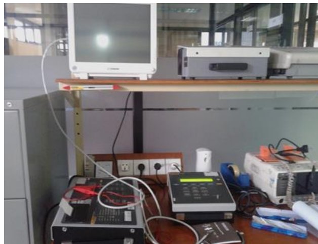
Pada foto ini adalah proses kalibrasi pasien monitor Zondan Apollo N4 menggunakan metode invasive, sebelum melakukan kalibrasi kami melakukan pengujian kebocoran arus, daya tahan perlindungan pembumihan menggunakan ESA untuk menguji keselamatan alat pasien monitor tersebut lokasi di PT Adi Multi Kalibrasi.
