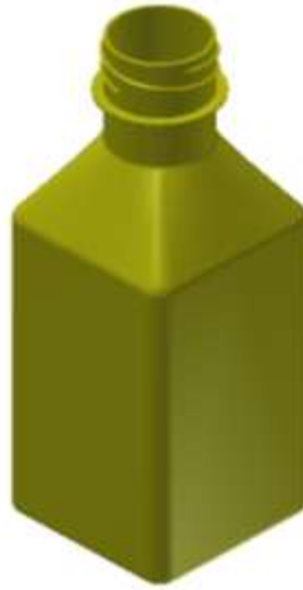
Gambar 4.5. Hasil produk desain 3D cetakan ( mold ) 1 dengan Autodesk inventor pro 2015
