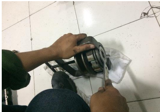
Gambar 3.10 Proses melepas sepatu kopling
