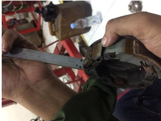
Gambar 3.18 Proses mengukur sepatu kopling
