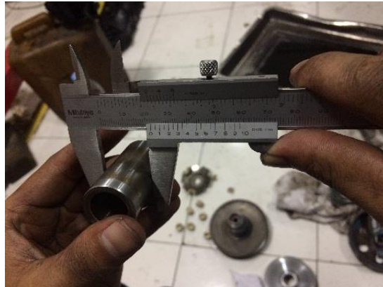
Gambar 3.12 Proses mengukur spacer
