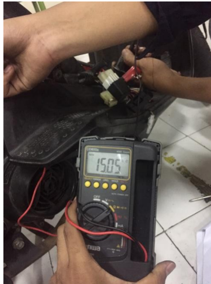
Gambar 4.2 Pengukuran Tegangan Output Pengisian “Pada gambar 4.2 pengukuran tegangan output pengisian dengan menggunakan multimeter yang di set pada selector DC 50 V dan hubungkan kabel positif multimeter dengan terminal positif baterai dan kabel negatif multimeter dengan terminal negatif baterai”.
