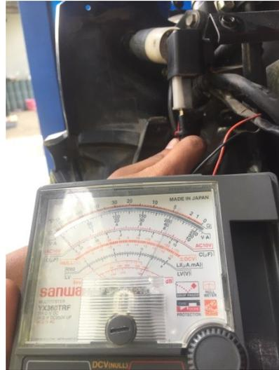
Gambar 3.14 Pemeriksaan Tegangan *Signal Relay*.
