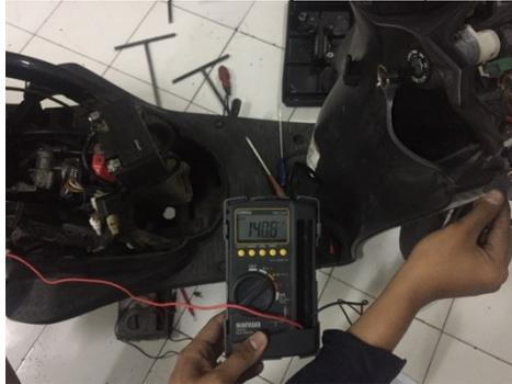
Gambar 3.7 Pemeriksaan tegangan coupler pada lampu rem atau lampu belakang
