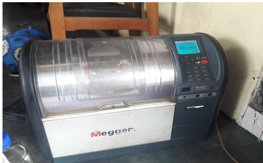
Gambar 4.1 Alat Penguji Tegangan Tembus Minyak Transformator
