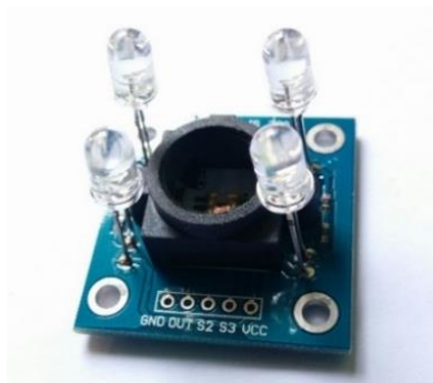
Gambar 2. 9 (a) bentuk fisik sensor TCS3200
