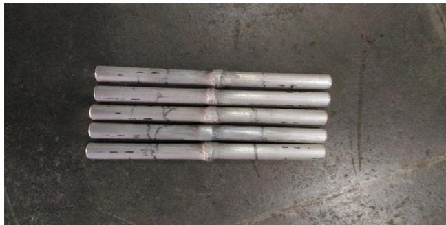
Gambar 4.5 Spesimen Pengujian Tarik.
