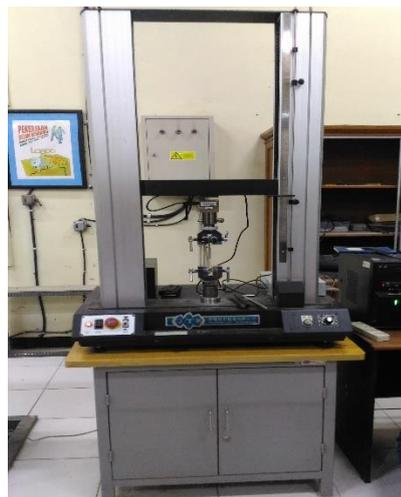
Gambar 4.7 Mesin Uji Tarik.
