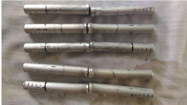
Gambar 4.6 Spesimen Setelah Dilakukan Pengujian Tarik.
