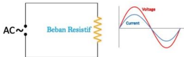
Gambar 2.4 Rangkaian dan gelombang beban resistif
