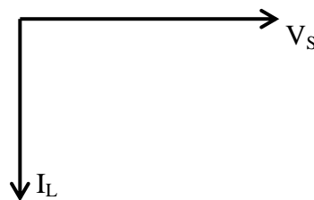
Gambar 2.7 Arah vektor tegangan dan arus beban induktif
