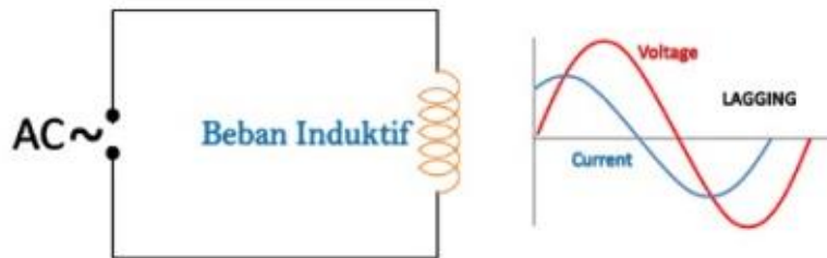
Gambar 2.6 Rangkaian dan gelombang beban induktif Sumber : duniaberbagiilmuuntuksemua.blogspot.co.id
