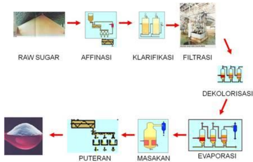
Gambar 2.3 Alur Proses Produksi pada Pabrik Gula Rafinasi (Fathurohman, 2015)
