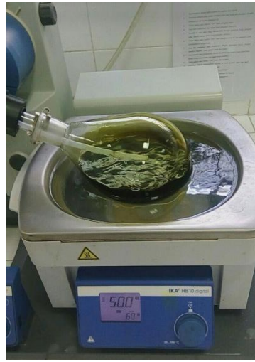
Ekstrak cair diuapkan menggunakan rotary evaporator
