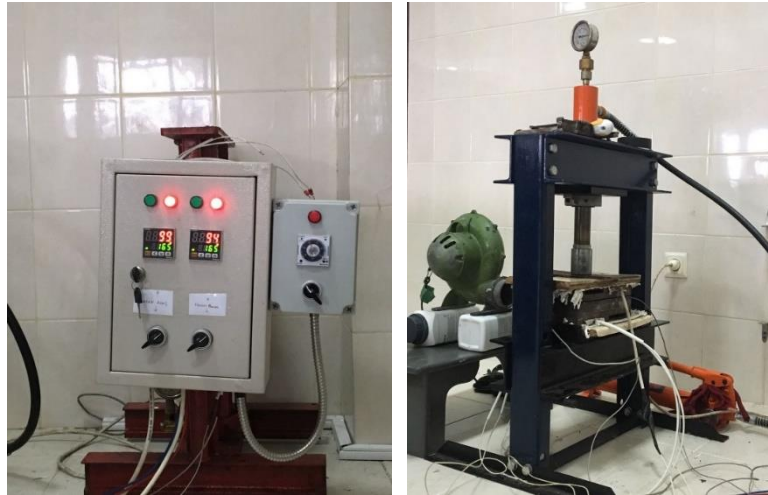
Gambar 3. 11 Hot Press dan Control Box
