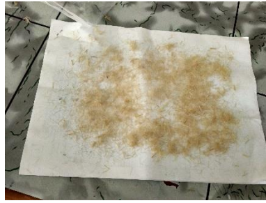
Gambar 3. 36 Serat Kenaf Yang Sudah Dipotong
