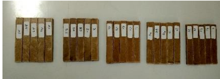
Gambar 3. 44 Spesimen Uji Impak Standar ASTM D5942
