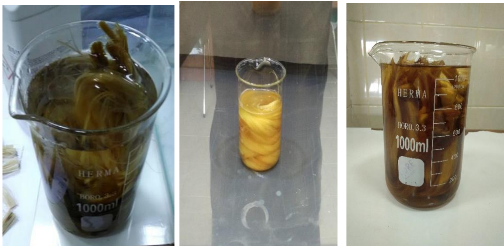
Gambar 3. 31 Perendaman Serat Alam dengan NaOH
