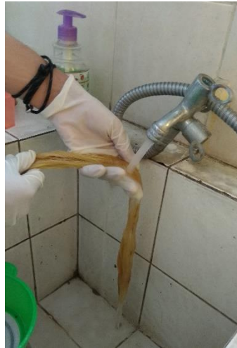
Gambar 3. 34 Proses Pembilasan Serat Alam
