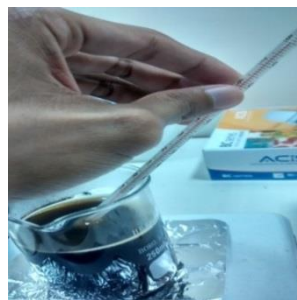
Gambar 3.17. Proses pembuatan larutan A (matriks Aloe vera /PVA)
