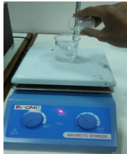
Gambar 3.16. Proses pembuatan larutan PVA 10% ( ^w/w )
