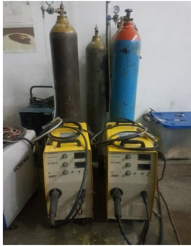
Gambar 3. 5 Mesin Las Tenjima MIG-200S
