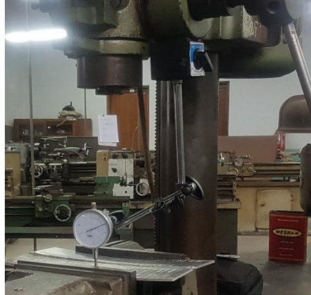
Gambar 3. 9 Posisi pengukuran distorsi di atas mesin milling .
