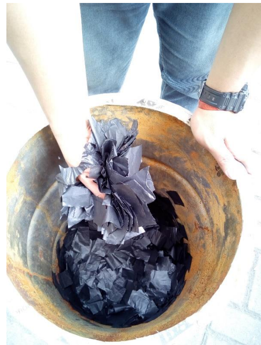
2. Plastik LDPE yg telah dipotong dan dimasukkan ke dalam reaktor
