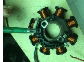
Gambar 4.2. Tap ground pada alternator
