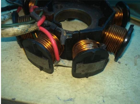
Gambar 4.3. Sambungan kabel dengan ujung kawat kumparan
