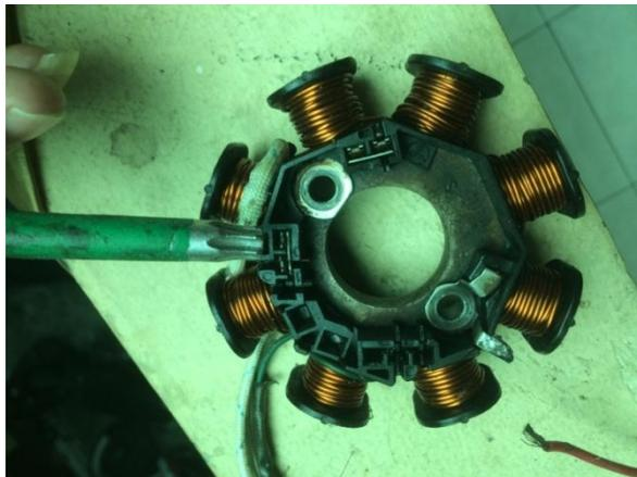
Gambar 4.2. Tap ground pada alternator
