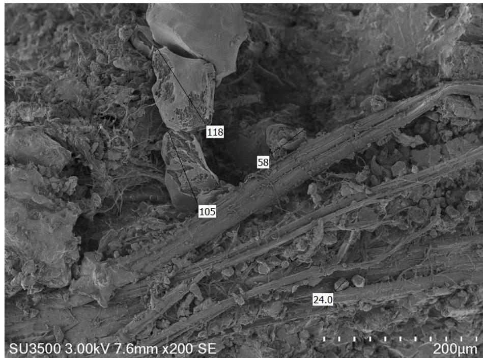
**Gambar 4.7** Ukuran Mikro Partikel  $\text{CaCO}_3$  Tanpa Ayakan.
