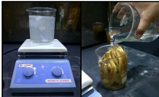
**Gambar 3.18** Melarutkan NaOH dan Alkalisasi Serat Kenaf.
