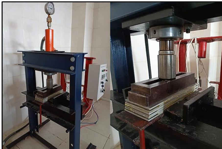
**Gambar 3.10** Mesin Rekayasa Press Dingin Manual.
