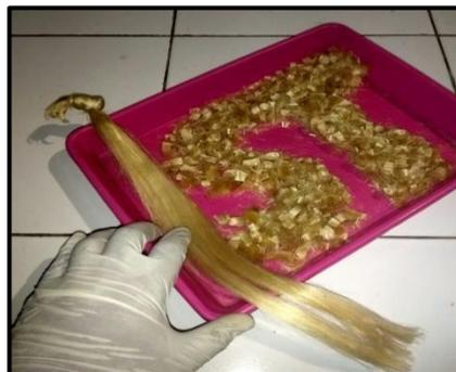
**Gambar 3.22** Pemotongan Serat Kenaf
