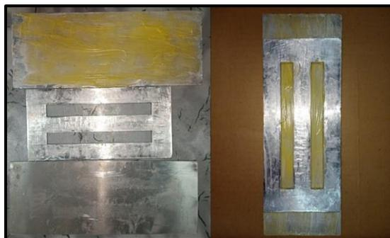
**Gambar 3.25** Pelapisan Cetakan Dengan *Mold Release*
