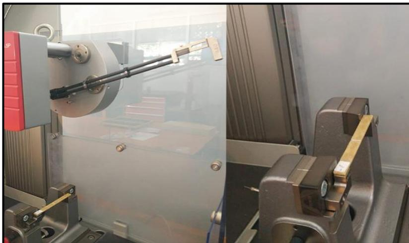
**Gambar 3.34** Peletakan Spesimen Pada Span.
