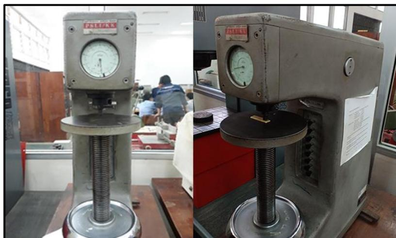
**Gambar 3.12** Alat Uji Kekerasan *Brinell*
