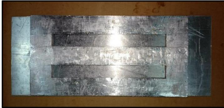
**Gambar 3.9** Cetakan Spesimen (benda uji).
