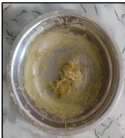
**Gambar 3.29** Pencampuran matriks dengan *filler*.
