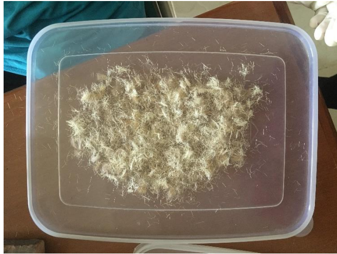
Gambar 3.27 Pencampuran serat nanas dan E-Glass
