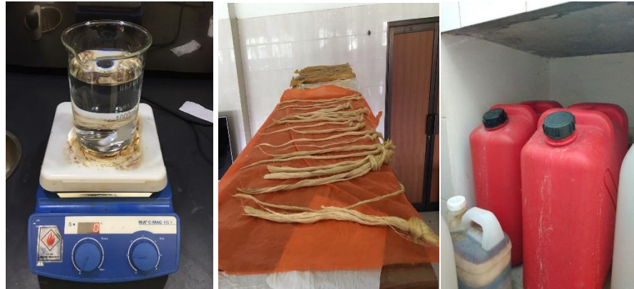
Gambar 3.20 Pelarutan dengan \text{CH}_3\text{COOH} lalu dijemur dan hasil limbah cair dibuang dalam jerigen
