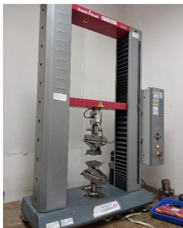
Gambar 3.9 alat uji tarik serat tunggal
