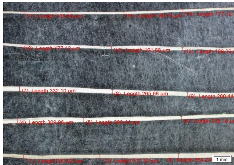
Gambar 3.22 Diameter serat nanas menggunakan mikroskop optik
