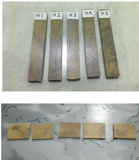
Gambar 3.31 Spesimen uji impact dan daya serap air
