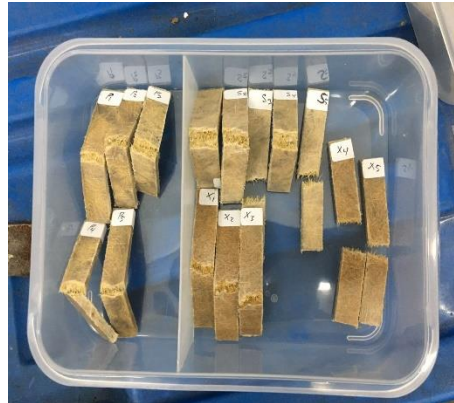
Gambar 3.34 hasil spesimen uji impact
