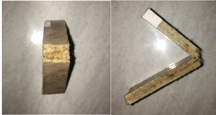
Gambar 3.36 Hasil patahan yang akan di karakterisasi dengan SEM
