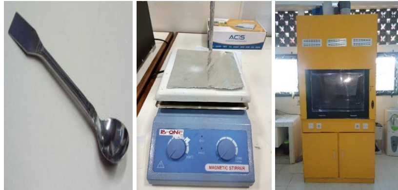
Gambar 3.2 Peralatan proses alkalisasi
