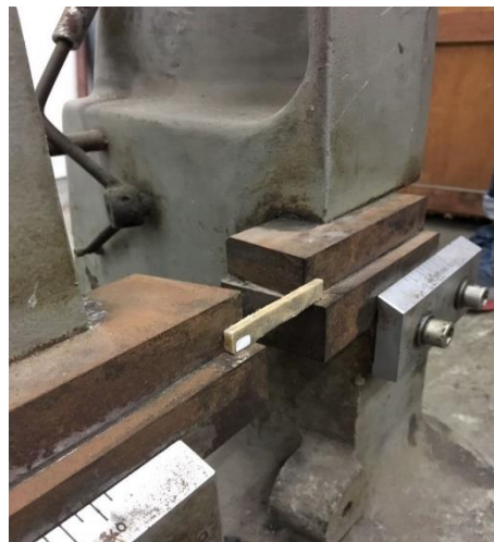
Gambar 3.33 Peletakan spesimen uji impak
