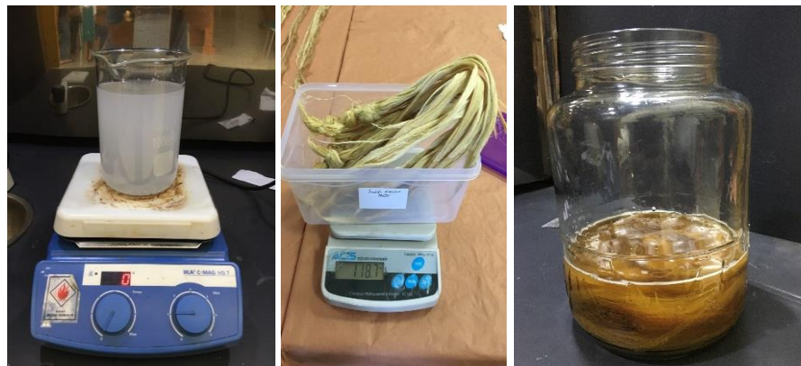
Gambar 3.19 pelarutan serat nanas dengan NaOH
