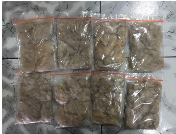
Gambar 3.26 Potongan serat E-Glass yang sudah ditimbang
