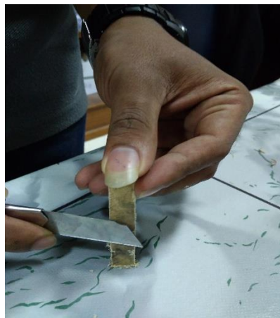
Gambar 3.32 proses penghalusan spesimen
