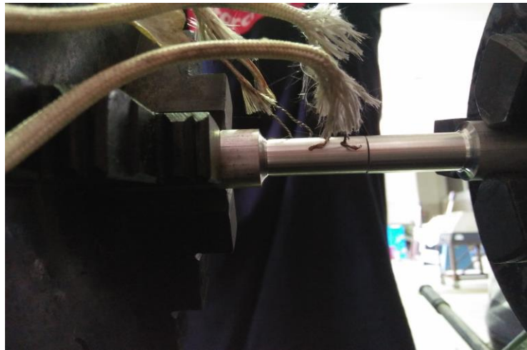
Gambar 4.1 Pemasangan termokopel pada spesimen yang diam yaitu Aluminium 6061 T6
