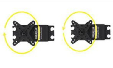
Gambar 2.23 Arah putar motor servo kontinyu
