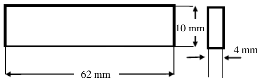
Gambar 2.1. Ukuran Spesimen Uji Impak (ASTM D 5942)
