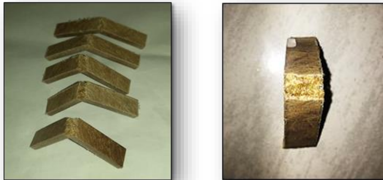
Gambar 2.3. Spesimen Uji Impak yang telah diuji
