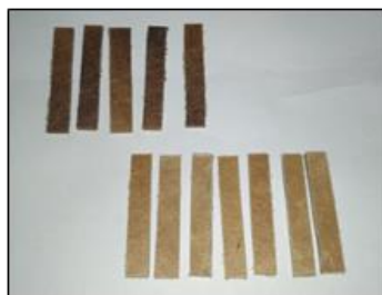
Gambar 2.2. Spesimen Uji Impak yang telah dipotong
