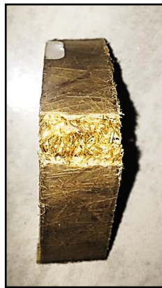
Gambar 3.26 Hasil patahan yang akan di karakterisasi dengan optik
