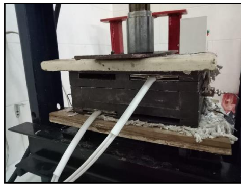
Gambar 3.21 Memasang heater dan sensor
