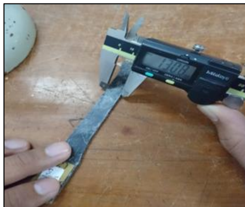
Gambar 3.13 Proses pengukuran lebar spesimen
