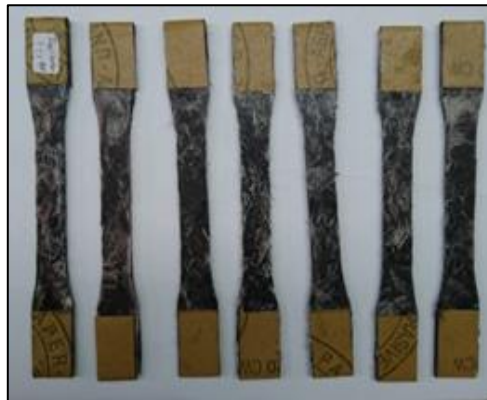
Gambar 3.12 Spesimen diberikan amplas dan label di ujungnya
