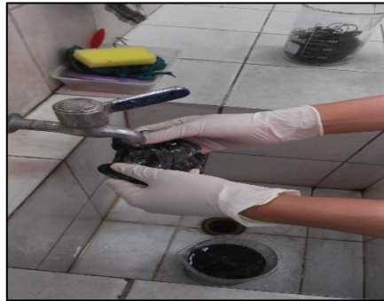
Gambar 3.3 Proses pencucian karbon dengan air mengalir
