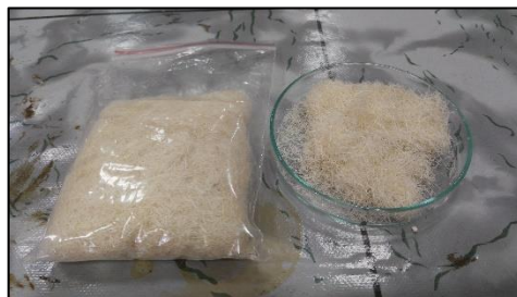
Gambar 3.2 hasil serat sisal dengan panjang 6 mm
