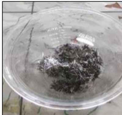
Gambar 3.9 Hasil pencampuran serat sisal dan karbon
