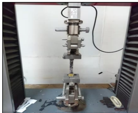
Gambar 3.15 Proses pengencangan spesimen
