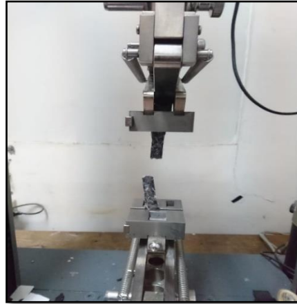
Gambar 3.16 Proses pengujian tarik spesimen sampai putus
