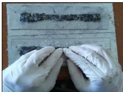
Gambar 3.10 Proses penataan dan penyusunan serat sisal dan karbon pada cetakan
