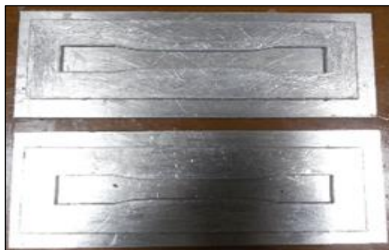
Gambar 3.8 Molding atau cetakan ASTM D638-01
