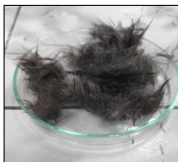
Gambar 3.5 Hasil karbon yang dipotong sepanjang 6 mm
