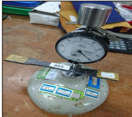
Gambar 3.14 Proses pengukuran ketebalan spesimen
