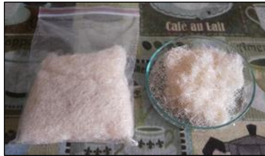
Gambar 3.6 Hasil perendaman aquades dan pemotongan serat sisal sepanjang 6 mm
