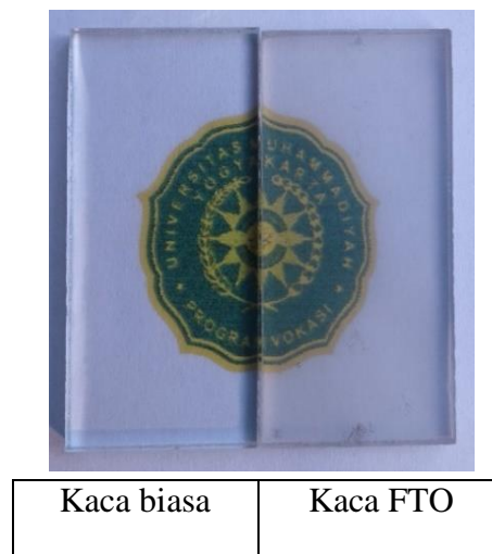
Gambar 4.5. Perbandingan kaca biasa dan kaca FTO temperatur sintering 400°C dan ketinggian jarak cerobong pengionisasi 1 cm
