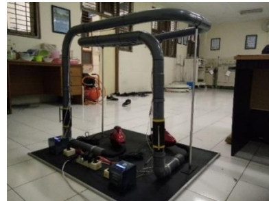
Gambar Alat Simulasi Pneumatic Tube Sebagai Alat Pengirim Sampel Berbasis Atmega8
