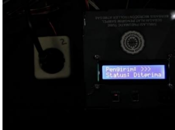
Tampilan LCD di ruang pengirim ketika carrier sudah sampai di ruang penerima.
