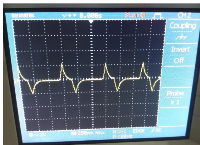
Gambar 4. 8 Bentuk gelombang output penguat 2 non inverting dan low pass filter 2
