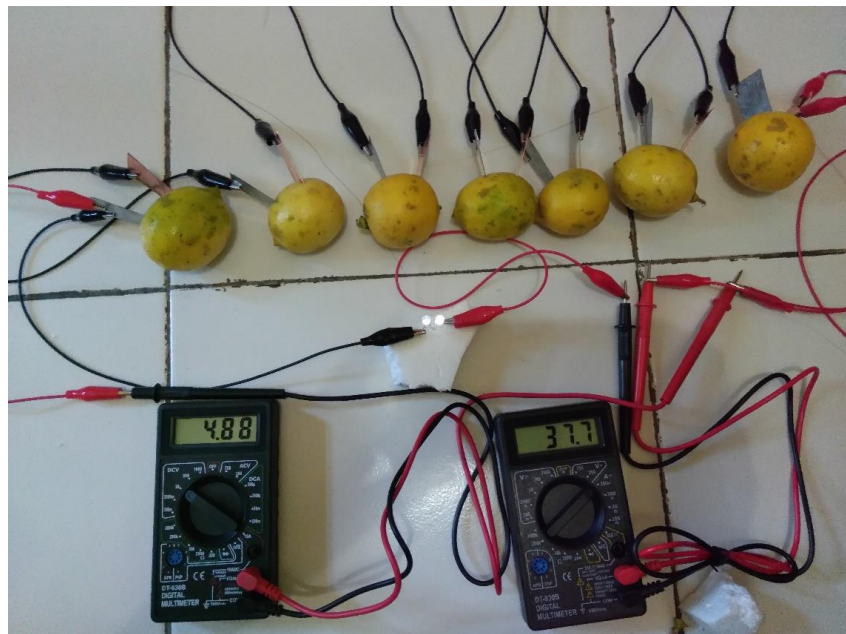
Gambar 4.12. Pengukuran dengan beban menggunakan 7x1 buah lemon utuh dan ketebalan elektroda yang berbeda
