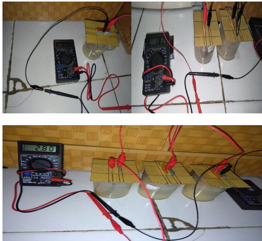
Gambar 4.6. pengukuran tanpa beban dengan 900cc ekstrak buah lemon dan ketebalan elektroda yang sama
