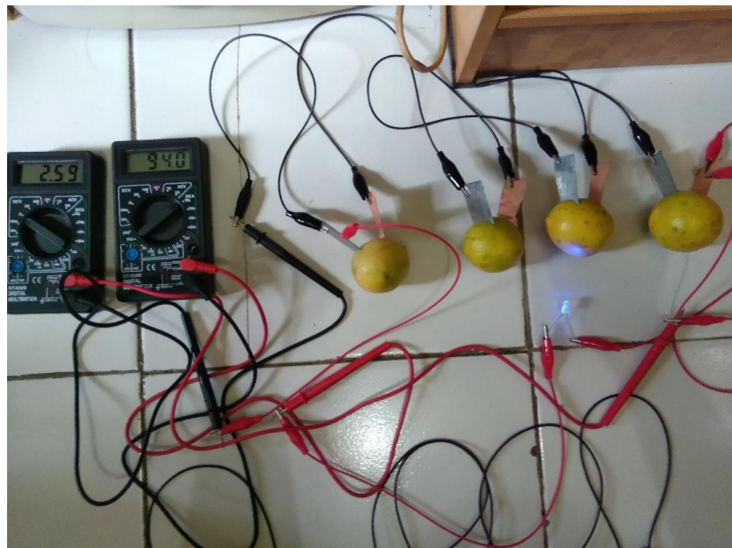
Gambar 4.6. Pengukuran dengan beban menggunakan 4x1 buah lemon utuh dan ketebalan elektroda yang berbeda
