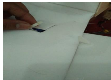
Gambar 4.20 Pemasangan dan penyambungan servo pada pesawat.
