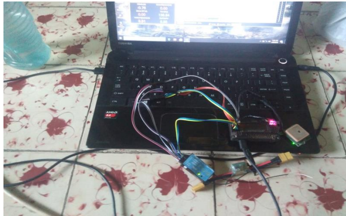
Gambar 4.24 Penyambungan Arduflyer 2.5 menggunakan kabel USB
