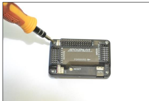
Gambar 4.16 Pemasangan mur dan baut pada Arduflyer 2.5
