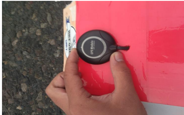
Gambar 4.48 Pemasangan Gps Module pada pesawat
