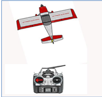
Gambar 2.4 Stik kemudi bagian kiri digerakan ke kiri untuk mengubah haluan pesawat ( http://www.hooked-on-rc-airplanes.com , 28 Juni 2013)
