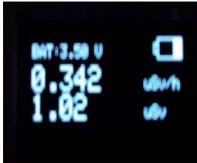
Gambar 3.4 Tampilan Nilai Dosis Pada *Display* OLED
