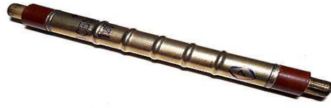
Gambar 2.4 Detektor Geiger Muller SBM-20 [9]
