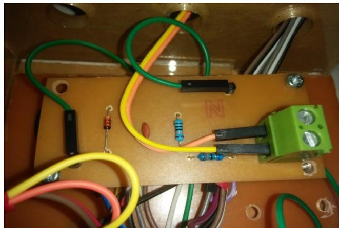
Gambar 4.6 Alat Pengukur Tegangan
