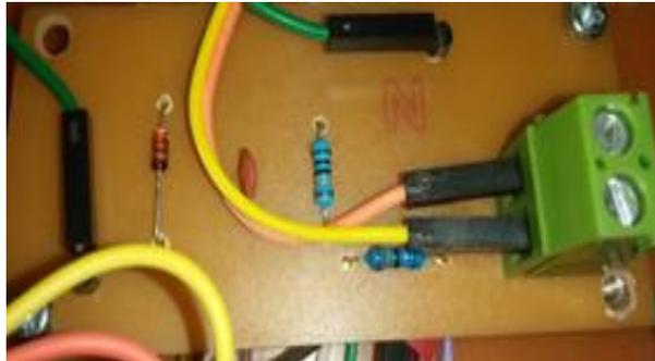
Gambar 2.16 Rangkaian pembagi tegangan.
