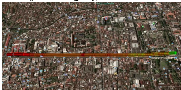
Gambar. 4.2. Hasil pengukuran RSRQ di Jalan Malioboro
