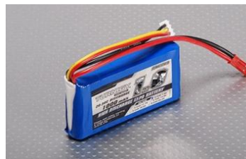
Gambar 2.10. Baterai Lipo Turnigi 1000mAh 2s
