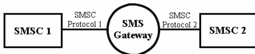
Gambar 2.1 SMS Gateway bertindak sebagai relay antara dua pusat SMS.
