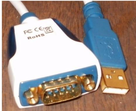
Gambar 2.4 Konverter dari USB ke port serial RS-232 yang kompatibel
