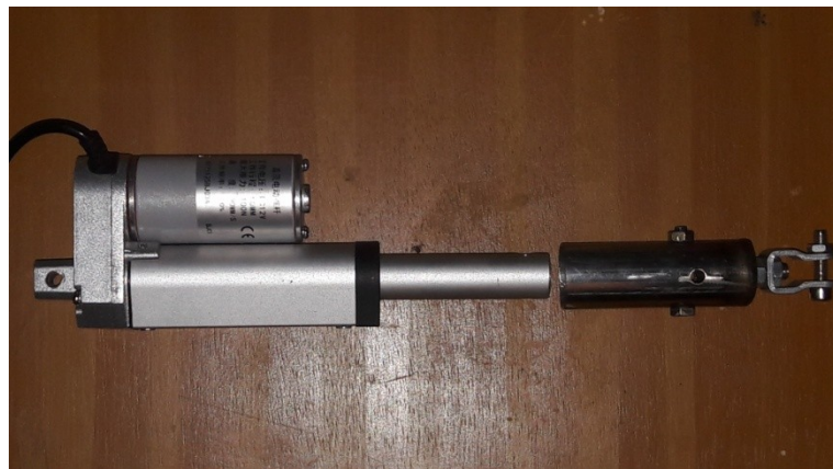
Gambar 4.4. Aktuator dan sambungannya
