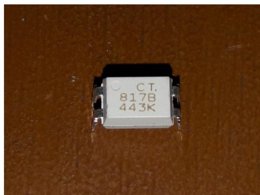
Gambar 2.26 Optocoupler PC817 yang digunakan untuk rangkaian
