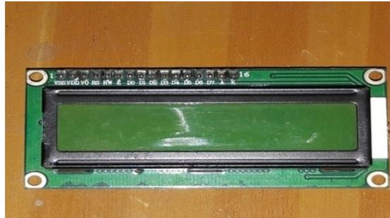
Gambar 2.20 Lcd 16x2 yang digunakan
